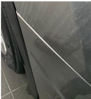
Если задний бампер в области задней арки выступает за поверхность крыла (~ 1—1,5 мм), то может потребоваться простейшая процедура:
