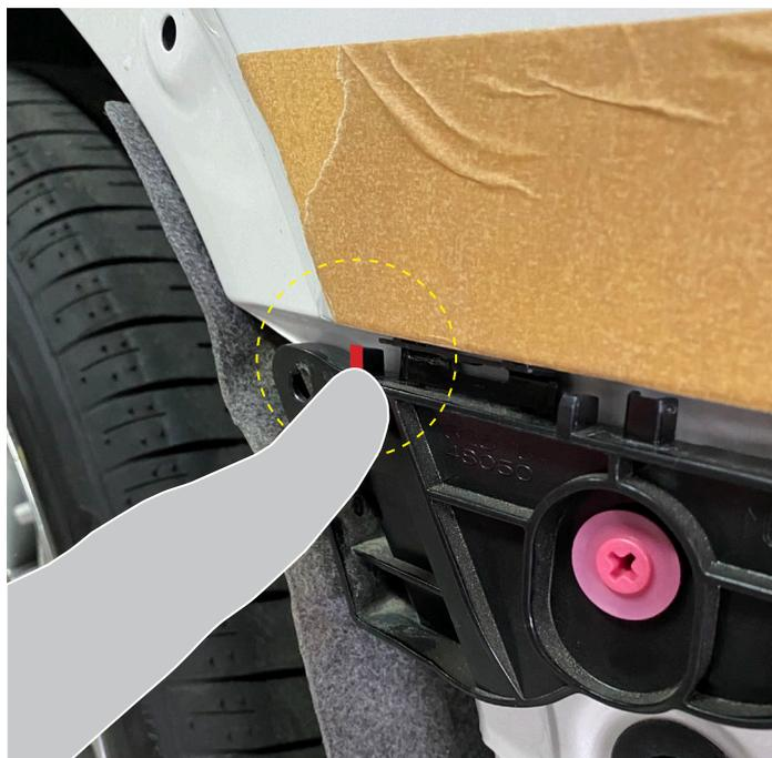
Отмеченную поверхность столбика срезаем на 1-1,5 мм.
