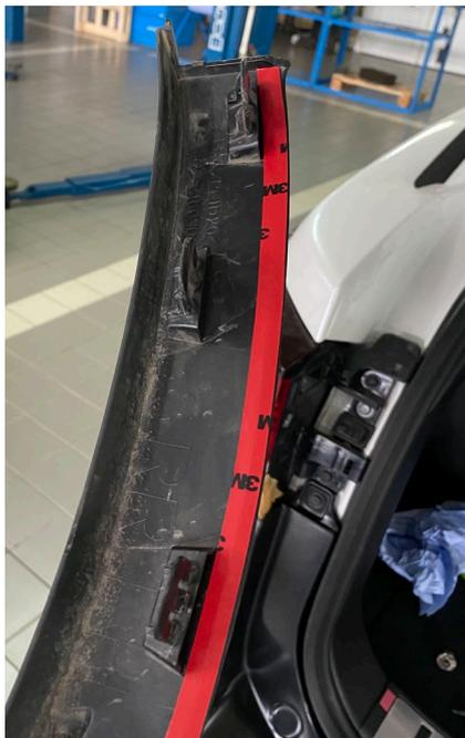
Наклеить на внутреннюю часть колесных арок двухстороннюю клейкую ленту (3М) отступив от внешней кромки 0,5—1 мм в 2 слоя друг на друга со смещением в 1,5—2 мм. Ленту клеить только на участок соприкосновения с бампером.
