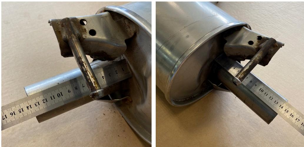
Отмеряем ~14 см от боковой стенки глушителя, отрезаем трубу. Повторяем процедуру с другой стороны.
