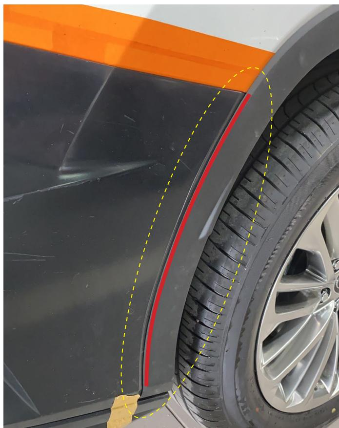
Участок приклеивания двухсторонней клейкой ленты в зоне соприкосновения с бампером (только с внутренней стороны колесной арки).
